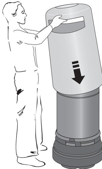
**5** Heben Sie die Haube über den Innenbehälter und setzen Sie diese auf den Sockel auf. Drehen Sie danach die Haube in die Öffnungen bis diese einrastet.
