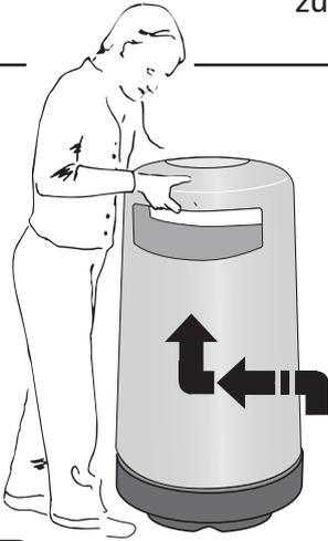
**1** Heben Sie die Haube des Topsy 2000 leicht an und drehen diese gegen den Uhrzeigersinn bis Sie zu einem Anschlag kommen. Jetzt halten Sie die Haube fest.
